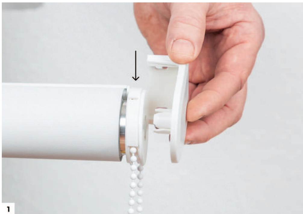
Slika 1: Ovalna vboklina na stranici roloja, nakazana s puščico, mora biti med montažo obrnjena navzgor.
